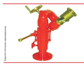
Canhão Monitor Fixo **GMF-470X**, desenvolvido para trabalhar com Água ou Espuma. Quando acoplado com esguichos GFE, o conjunto torna-se ideal para o combate a incêndios em líquidos inflamáveis. Fornecido com Válvula Esfera de passagem plena com 1/4" de volta integrada, para rápida liberação da água para combate.
