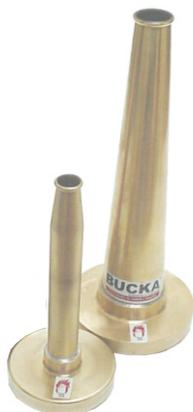
Esguicho Jato Sólido modelo BUCKA JS, fabricado em latão e tubo em cobre sem costura, fornecido nos requintes 5/8" (13 mm) e 1/2" (16 mm) para esguicho 1.1/2" Storz e 3/4" (19 mm) e 1" (25 mm) para esguicho 2.1/2" Storz.
