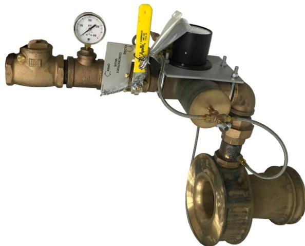
O proporcionador em linha de pressão balanceada (IBP - Inline Balanced Pressure) trabalha mantendo um equilíbrio de pressões nas entradas de LGE e água.
