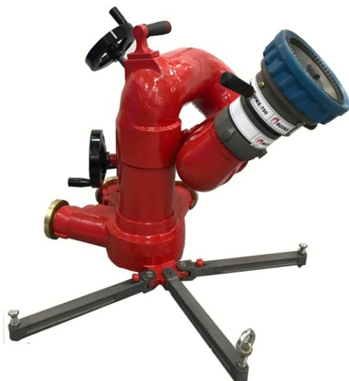
O canhão monitor portátil GMP-750 foi desenvolvido para obter vazões de até 7.570 LPM (2.000 GPM), na configuração com 2 entradas de 4", corpo totalmente fabricado na dimensão de 3.1/2",
