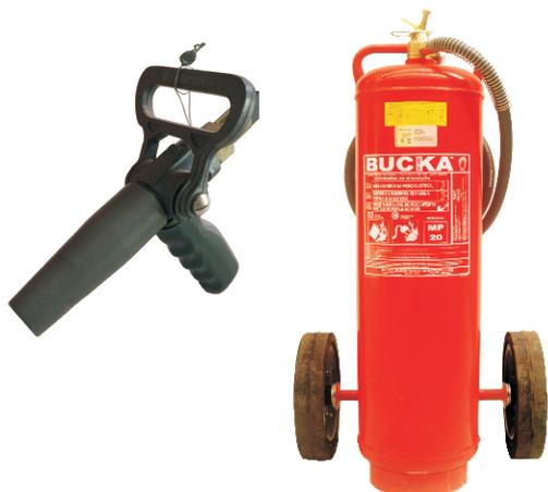
Extintor de incêndio sobre rodas, com carga de pó químico seco à base de bicarbonato de sódio (Totalit Super), fabricado de acordo com a norma NBR 15809. Fabricado em chapa de aço carbono com pressurização direta com nitrogênio (N<sub>2</sub>).
