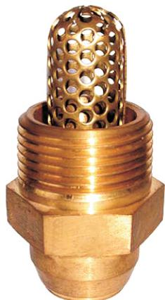
Bico para sistema de água nebulizada, modelo HV, alta velocidade com densidade uniforme. Bico com orifício normalmente aberto, jato cônico, empregado na extinção de incêndios em líquidos combustíveis com ponto de fulgor acima de 66° C.
