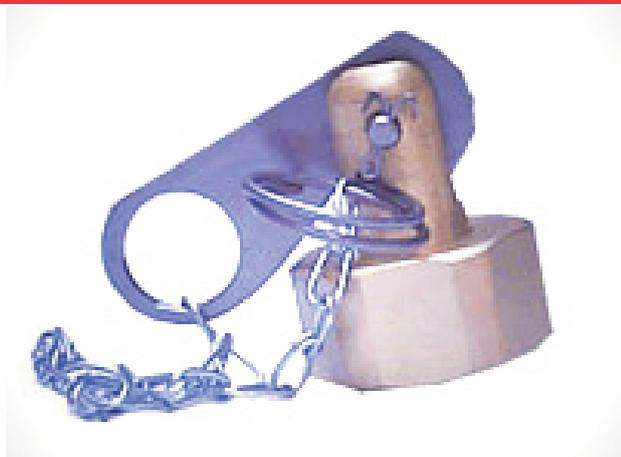
Atuador manual da bateria de cilindros de CO2. Instalada na válvula do cilindro piloto, permite a liberação de CO2 para a área sinistrada.
