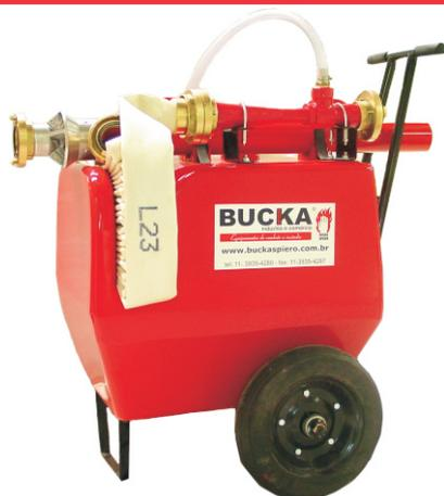
Carreta de Espuma CE-200, projetada para proporcionar espuma com mobilidade e autonomia, composta de tanque de fibra de vidro sobre rodas com capacidade para armazenar 200 litros de LGE, pode ser fornecida em três configurações: 200 / 400 / 800 LPM
