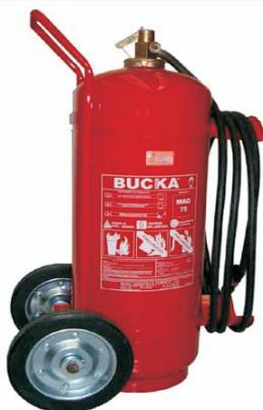
Extintor de incêndio sobre rodas, com carga de água potável, fabricado com a norma ABNT NBR 15809, em chapa de aço carbono SAE 1010/1020. A sua pressurização é direta com nitrogênio.
