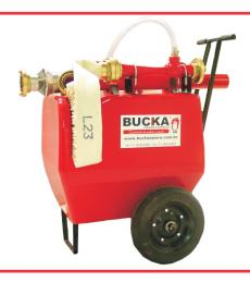
Carreta 130L projetado para proporcionar espuma com mobilidade e autonomia, composto de tanque de fibra de vidro sobre rodas com capacidade para armazenar 130 litros de LGE, pode ser fornecida em três configurações: 200 / 400 / 800 LPM
