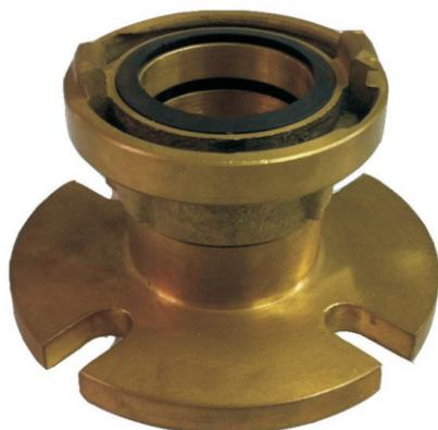
Conexão Internacional, entrada flangeada Ø2.1/2" com 4 furos, saída conexão tipo Storz Ø2.1/2" padrão ABNT NBR.
