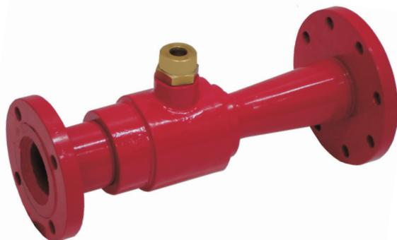
Os Proporcionadores de Linha Fixos do tipo PL foram projetados para succionar LGE para uma linha de água pressurizada utilizando o sistema Venturi de aspiração.
