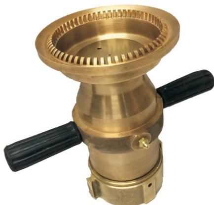
Esguicho modelo DN-Flux foi projetado para trabalhar com vazão de até 1.000 GPM no lançamento de água ou espuma, em jato sólido ou neblina, com baixa perda de carga e pressão de operação.
